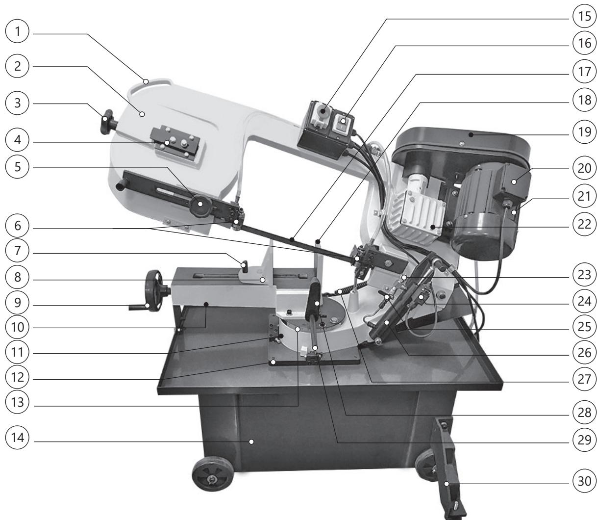
*Рисунок 1. Основные элементы станка MBS-884CH и MBS-884CH/400.*
